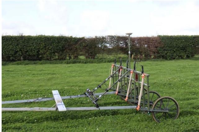
**Fig. 1** – Système Mag-EM tracté utilisé par l’Inrap.
